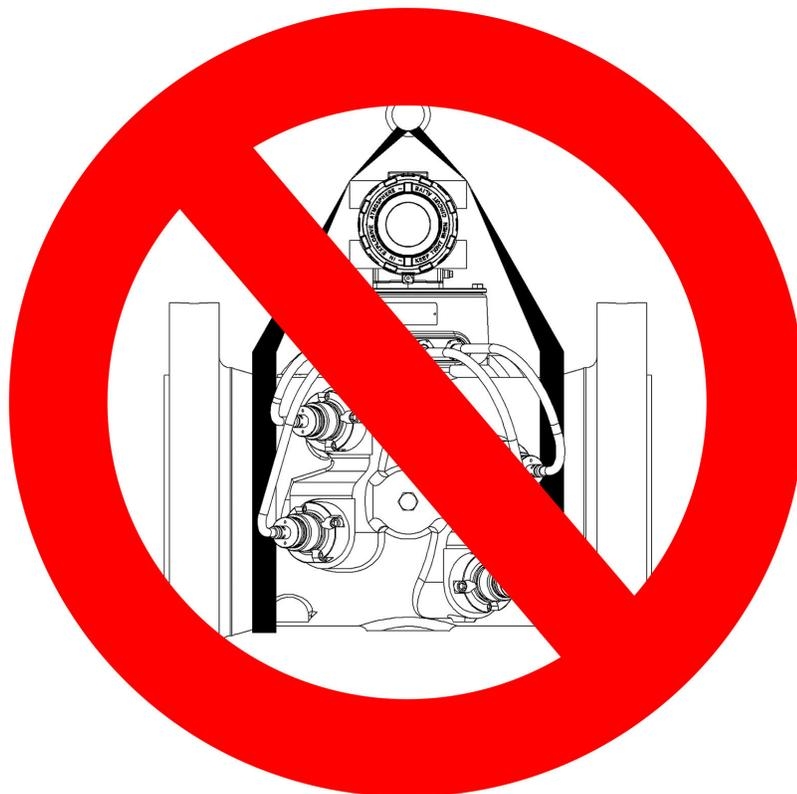
8. No aplique NUNCA cargas bruscas al medidor. Eleve siempre gradualmente el medidor. Si alguna vez se produce una carga brusca, se deben inspeccionar las eslingas según las recomendaciones del fabricante antes de volver a utilizarlas.
