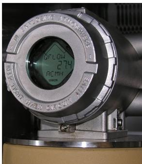
La homologación de seguridad U.L. de todos los caudalímetros ultrasónico Rosemount se logra mediante la combinación de una caja de la electrónica del transmisor a prueba de explosiones que aloja el módulo de CPU, la tarjeta de la fuente de alimentación, la tarjeta de barrera I.S., la tarjeta de bus de fondo y la tarjeta de indicador LCD opcional.
