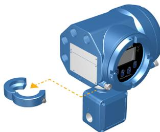
2. Girar gentilmente a caixa de junção para a posição desejada. Você pode girar a caixa de junção a mais ou menos 180° para qualquer posição.
