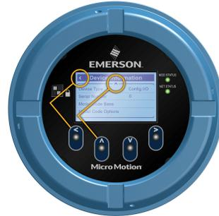
Figura 9-3: Exemplo 2: indicadores de seta ativos no display do transmissor
