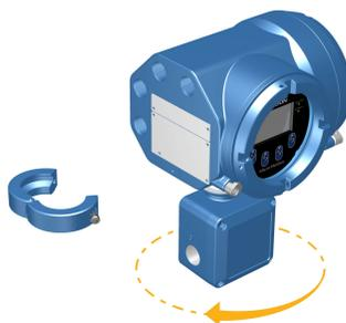
3. Gentilmente, ajuste a caixa de junção em sua nova posição, confirmando que a posição está bloqueada.
