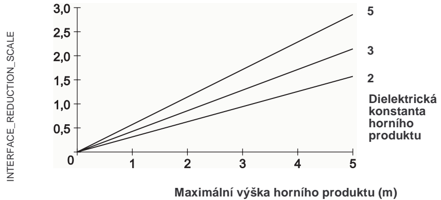
Redukce maximálního měřicího rozsahu dvoulanové sondy pro různé hodnoty dielektrické konstanty horního produktu. (m)
