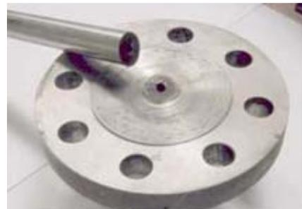
*Esempio di un guasto a un pozzetto termometrico causato dalla vibrazione indotta da vortici<sup>(1)</sup>*
