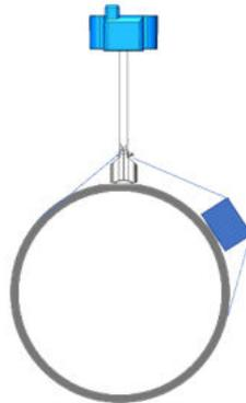
Kontaktfläche ist zu groß – Sensor und Bandspanner sind zu weit voneinander entfernt.
