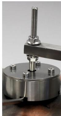
5. Die Schutzkappe unter die Magneteinheit schieben und den Schraubendreher wie in [Abbildung 5-5](#) abgebildet entfernen.
