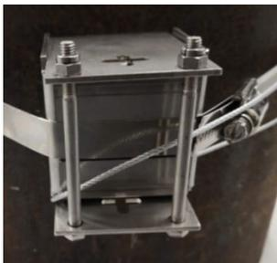
5. Das blanke Ende durch die Banddurchführung jedes Sensors, die Sicherungsseil-Befestigungsbohrung im Sensorkopf und dann in die Rücklaufbohrung des Kabelschlosses führen.
