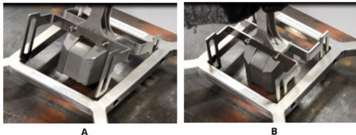
A. Sensor in einem Winkel zum Behälter platzieren
