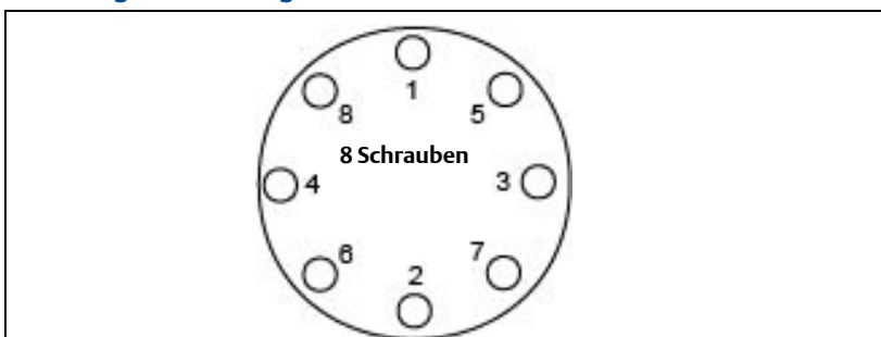
Abbildung 8. Reihenfolge für das Anziehen der Flanschschrauben
