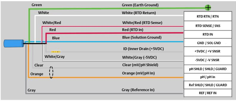
**Tabelle 1-3: Verkabelung des Rosemount 3900/3900VP mit Vorverstärker mit Rosemount 56/1056/1057/1066 Messumformern**
