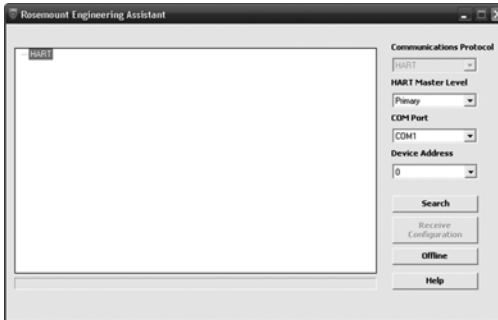
Abbildung 10. Bildschirm „Device Connection“ (Angeschlossene Geräte) des Engineering Assistant
