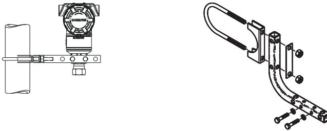
Abbildung 2-6: Rohrmontage, Rosemount 3051T
