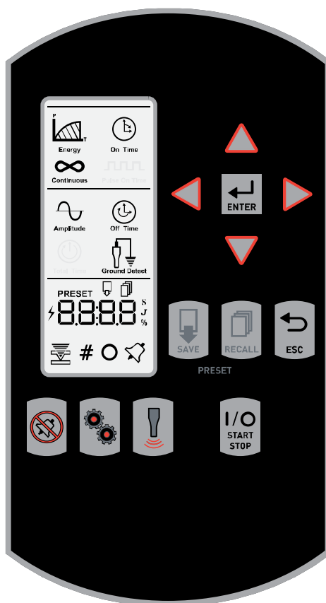
Ábrá 6.1 LPX tápegység felhasználói felület
