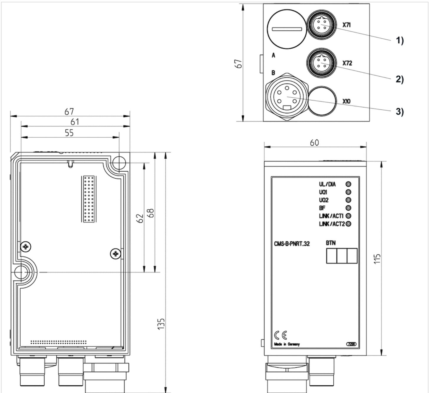
1) Bus IN 2) Bus OUT 3) Spannungsversorgung
