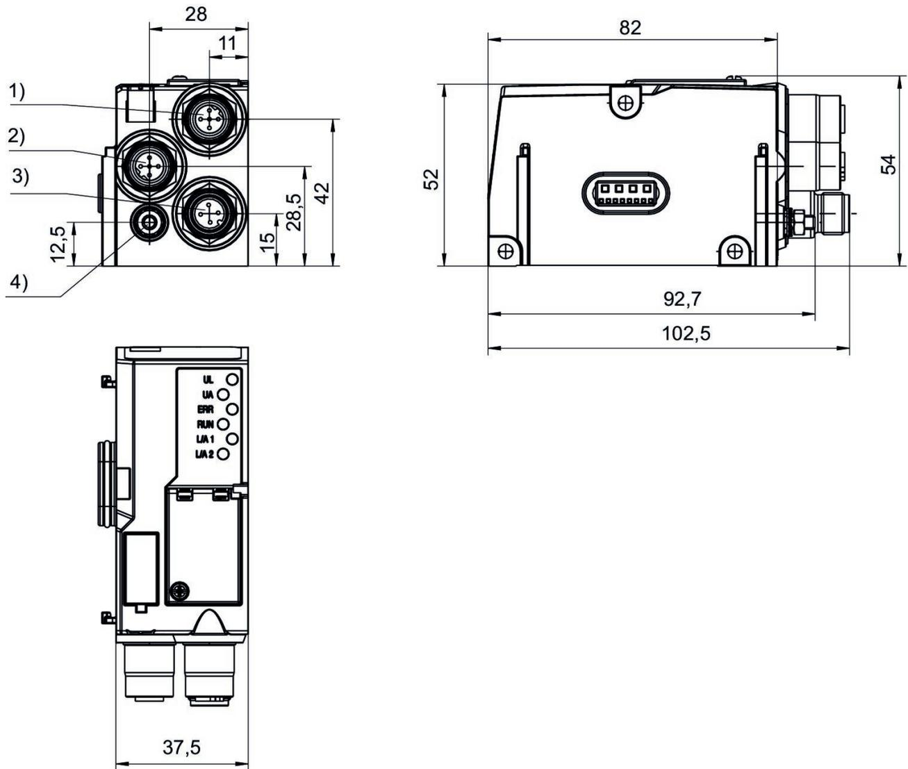
1) Anschluss Feldbus 2) Anschluss Feldbus 3) Spannungsversorgung 4) Funktionserde
