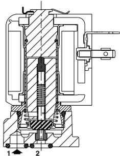
FPM Ventilteller und Dichtung, Edelstahlgehäuse, mit Handhilfsbetätigung
