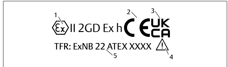
Abb. 3: Typenschild für den mechanischen Explosionsschutz
