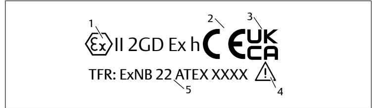
Bild 3: Typeskyld för mekaniskt explosionskydd
