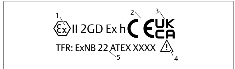
Abb. 3: Typenschild für den mechanischen Explosionsschutz
