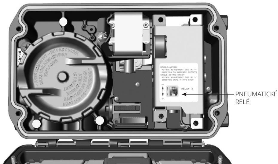
Obr. 20. Umístění pneumatického relé
