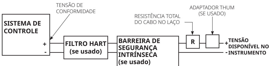
Figura 3. Determinação da tensão disponível no instrumento
