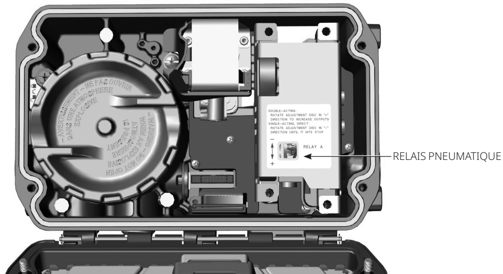
Figure 20. Emplacement du relais pneumatique
