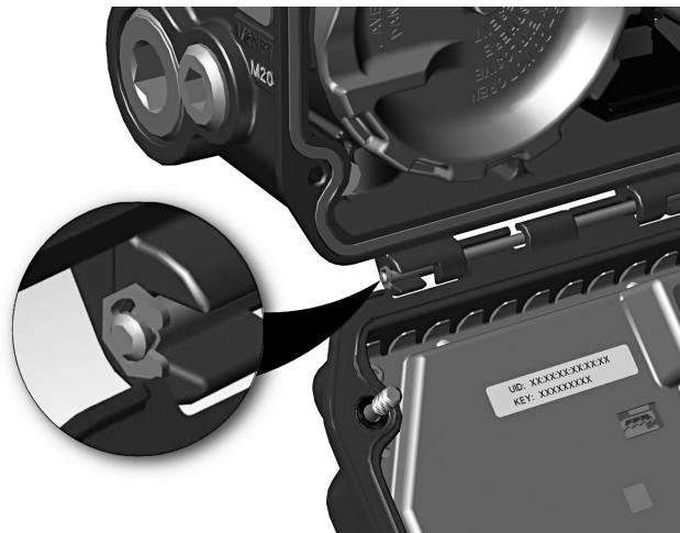
Figura 16. Ubicación del anillo en E y del pasador de bisagra
