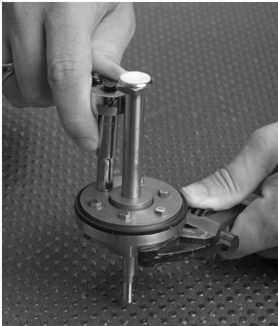
Figure 5. Utiliser l'outil fourni ou l'ensemble siège de ressort (n° 4) et tige (n° 2) pour aligner la bague de maintien (n° 8)
