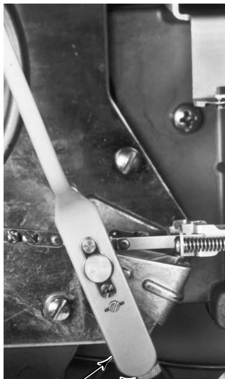
Рис. 5-6. Выравнивание указателя давления процесса
