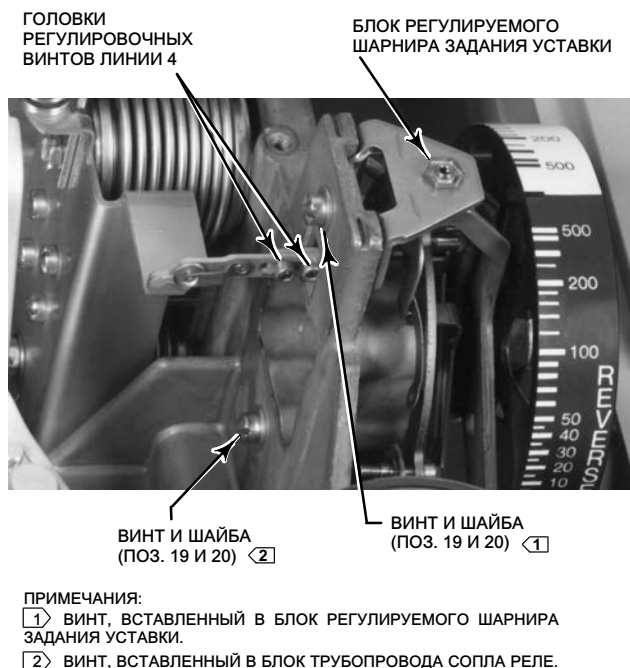
Рис. 5-12. Расположение регулировочных винтов линии номер 4
