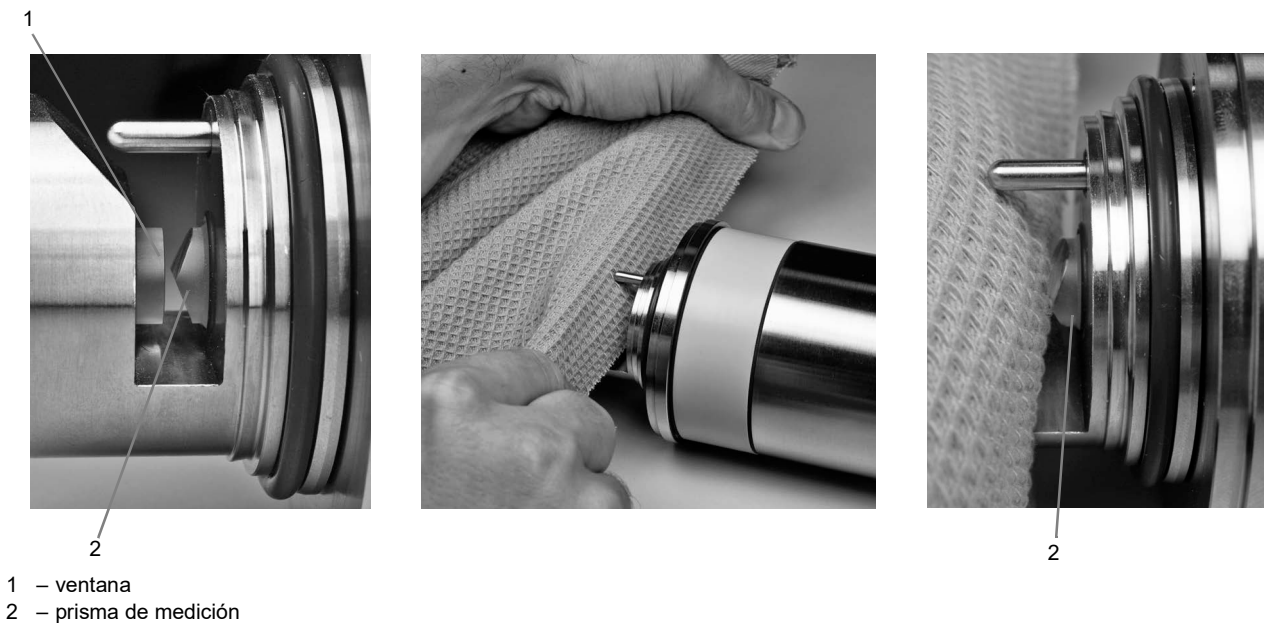
Fig. 11.1: Limpieza del prisma de medición y de la ventana
