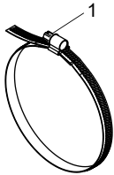
Fig. 6.44: Cinta de sujeción con cierre tensor
