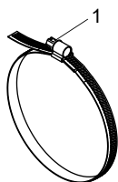
Fig. 6.25: Cinta de sujeción con cierre tensor
