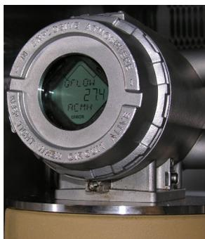
Die UL-Sicherheitseinstufung der Rosemount Ultraschall-Durchflussmesssysteme basiert auf der Kombination mit einem Ex-geschützten Gehäuse für die Messsystemelektronik, in dem das CPU-Modul, die Platine für die Spannungsversorgung, die Platine für die eigensichere Barriere, die Backplane-Platine und optional die Platine für das LCD-Display untergebracht sind.
