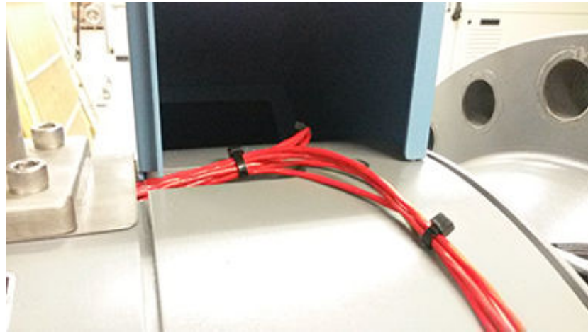
Abbildung 3-25: Schutzabdeckung am Fixierstift hängend
