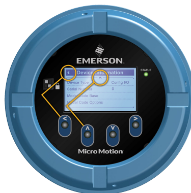
Abbildung 8-2: Beispiel 1: Aktive Anzeigepfeile auf dem Display des Messumformers
