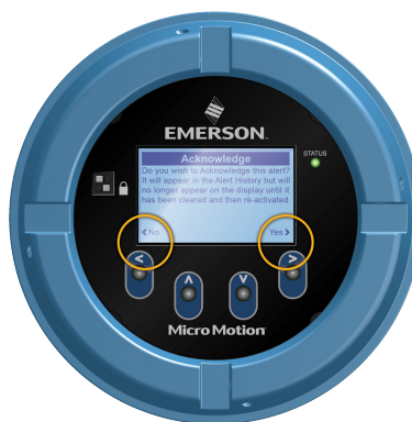
Abbildung 8-3: Beispiel 2: Aktive Anzeigepfeile auf dem Display des Messumformers
