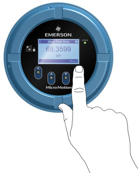
2. Die für die Bildschirmnavigation zu verwendenden optischen Schalter werden über die Pfeile auf dem Bildschirm des Displays angezeigt (siehe Beispiel 1 und 2).
