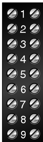
Abbildung 5-8: Anschlussklemmen aller Sensoren des Typs D und DL sowie der F-Serie bis zum Jahr 2005
