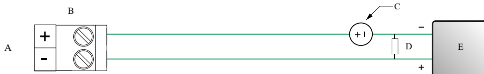
Abbildung 4-3: Verkabelung des Frequenzausgangs mit externer Spannungsversorgung
