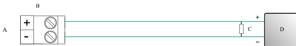
Abbildung 4-4: Verkabelung des Frequenzgangs mit interner Spannungsversorgung
