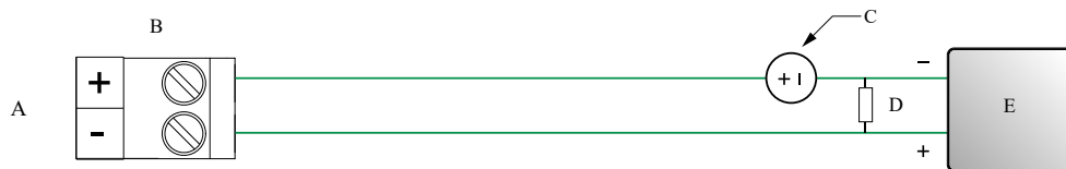
Abbildung 4-6: Verkabelung des Frequenzausgangs mit externer Spannungsversorgung
