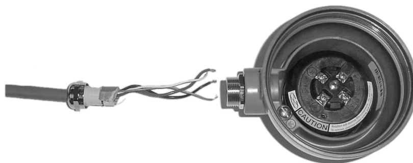
Kuva 3-7 Läpivientiholkin runko ja anturielektroniikan kotelo
