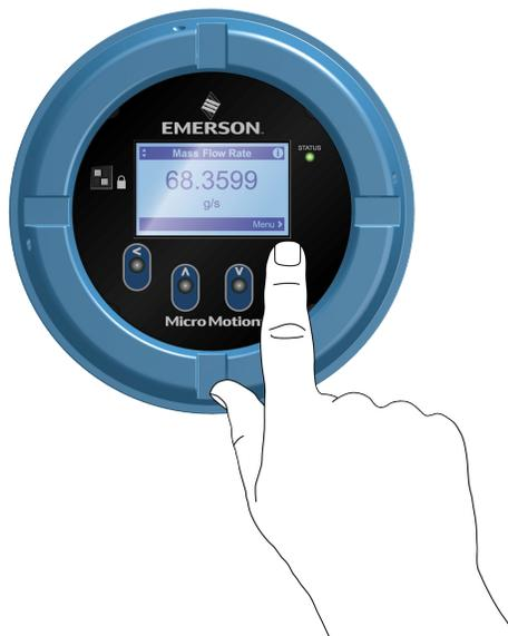
2. Используя стрелочные индикаторы на дисплее определите, какой из оптических переключателей необходимо использовать для навигации (как показано в примерах 1 и 2).
