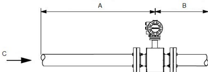
Figur 3-1: Oppstrøms og nedstrøms rette rørdiametere
