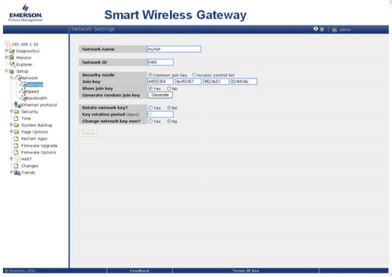
Figur 7. Nettverksinnstillinger for gatewayen
