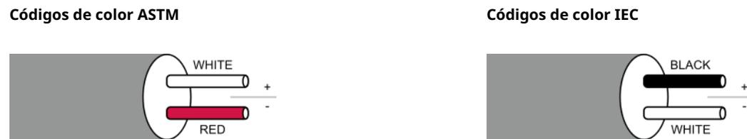
Los termopares tipo J están contruidos de hierro y constantán, y tienen un rango de temperatura potencial de -40 a 1400 °F (-40 a 760 °C), y una sensibilidad de aproximadamente 50 μV/°C. Los termopares tipo J se vuelven frágiles por debajo de 32 °F (0 °C) y son adecuados para usarse en entornos al vacío, reductores o inertes. Estos termopares tendrán una vida útil reducida si se utilizan en un entorno oxidante.
