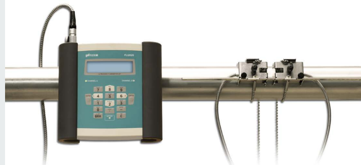
Medición con transductores montados mediante dispositivos de fijación, y con transmisor de caudal fijado mediante sistema de fijación al tubo QuickFix
