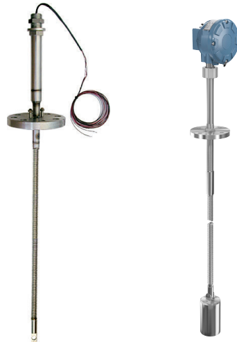
Figure 6.2 : Gauche – Sonde de température multipoint avec éléments Pt100 et gaine métallique résistante à la corrosion. Droite – Ensemble de mesure de température complet avec transmetteur, sonde, capteur de niveau d'eau en option et lest d'ancrage.
