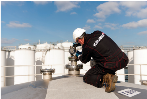
Figure 2.2 : Jaugeage manuel à l'aide d'un ruban.
