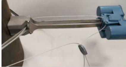
6. Insérer le fil du cordon dans le verrou de câble pour minimiser le jeu dans le fil.
