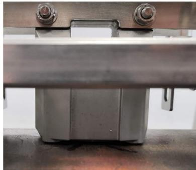
8. Installer les 4 boulons, rondelles et écrous de fixation du capteur sur le support magnétique comme illustré à la [Illustration 4-11](#).
