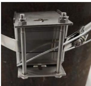
5. Insérer l'extrémité dénudée dans l'orifice de sangle de chaque capteur, le trou du cordon dans la tête du capteur et dans le trou de retour du verrou de câble.
