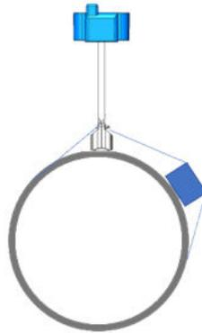
Zone de contact trop grande. Le capteur et le tendeur sont trop éloignés l'un de l'autre.
