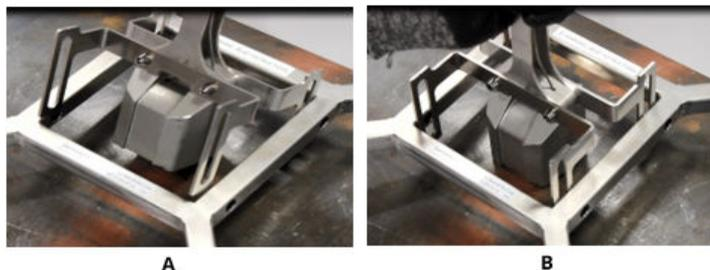
A. Placer le capteur à un angle par rapport au bac
