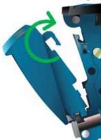
3. Pousser le connecteur de borne vers le bas pour le mettre correctement en place.
