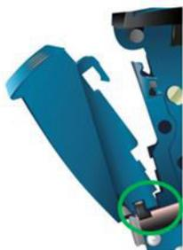
2. Tourner les crochets en plastique de sorte qu'ils soient correctement engagés dans la pièce en plastique de support.
