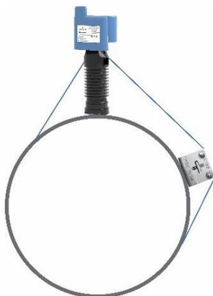
Zone de contact trop grande. Le capteur et le tendeur sont trop éloignés l'un de l'autre.
