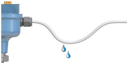
8. Obturer de manière hermétique le raccordement de câble non utilisé pour éviter l'accumulation d'humidité et de poussière à l'intérieur du boîtier.
