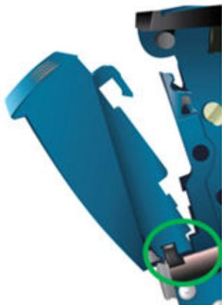
2. Ruotare i ganci di plastica in modo che si inseriscano correttamente nel pezzo di plastica di supporto.
