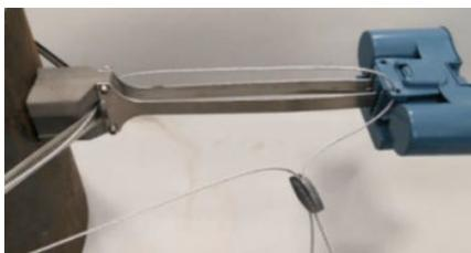
6. Far passare il cavo del cordino attraverso il blocco del cavo per ridurre al minimo il lasco.
