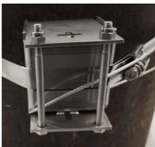
5. Far passare l'estremità libera attraverso il foro della fascetta di ogni sensore, il foro del cordino nella testa del sensore e nel foro di ritorno del blocco del cavo.
