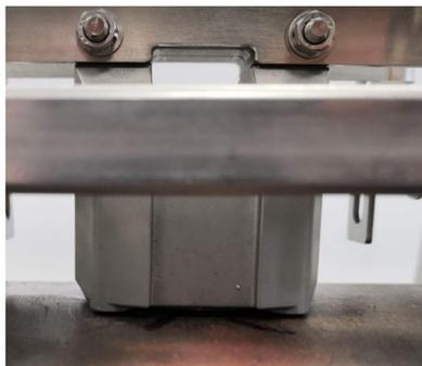
8. Montare i 4 bulloni di fissaggio del sensore, le rondelle di bloccaggio e i dadi del supporto magnetico come mostrato nella [Figura 4-11](#).
