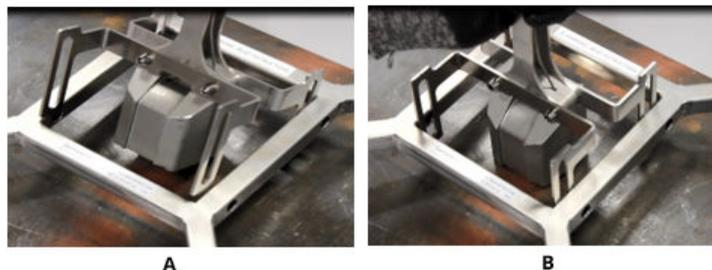
A. Posizionare il sensore ad angolo rispetto al serbatoio
