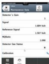
**Figura 2-4: Schermate visualizzate durante la calibrazione a zero con software WinHost®**
