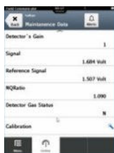
Figura 2-3: Calibrazione a zero con un comunicatore portatile
