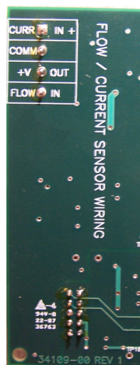
Figura 3-12: Scheda di segnale d'ingresso flusso/corrente e conduttori del cavo del sensore
