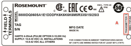
Figura 5-15: Targhetta sui trasmettitori Quad
