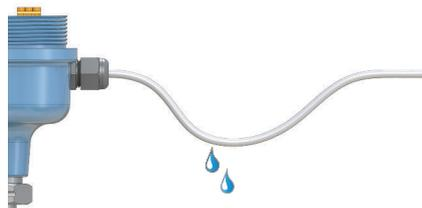
8. Chiudere e sigillare la connessione del conduit non utilizzata per evitare l'accumulo di umidità e polvere all'interno della custodia. Applicare nastro in PTFE o altro sigillante sulle filettature.
