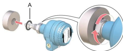
A. Guarnizione per connessione filettata BSPP (G)
