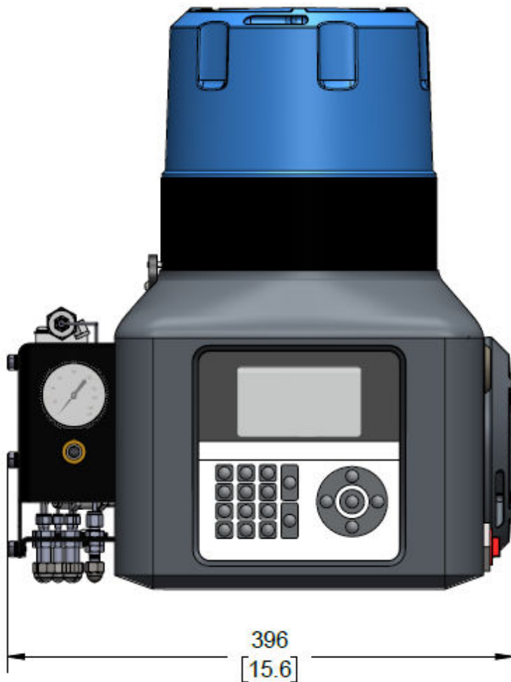
Figura 1-3: Dimensioni di ingombro del Rosemount 470XA
