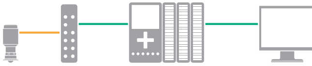
Figura 7-3: Conexão através do PLC
