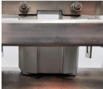
8. Encaixe os quatro parafusos de fixação do transmissor, arruelas e porcas do dispositivo magnético, conforme mostrado na [Figura 4-11](#).
