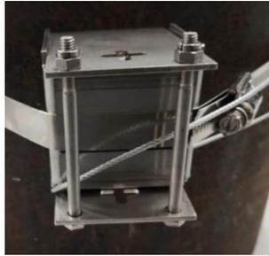
5. Passe a extremidade descoberta do talabarte de segurança através do orifício da correia de cada transmissor, o orifício do talabarte de segurança na cabeça do transmissor e para dentro do orifício de retorno da trava do cabo.
