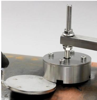
6. Deslize a unidade magnética até o fim sobre a tampa protetora, conforme exibido na [Figura 5-6](#).
